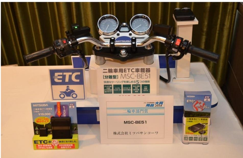
二輪車用ETC車載器「MSC-BE51」は、高い基本性能をシンプルかつ低価格で実現した分離型のETC。シンプルな表示とデザインを実現した。19,000円（税別）という低価格ながら、防水、防塵は「IP55」規格をクリアしたほか、20Gまでの振動加速度試験もクリアするなど高い基本性能を誇っている。
